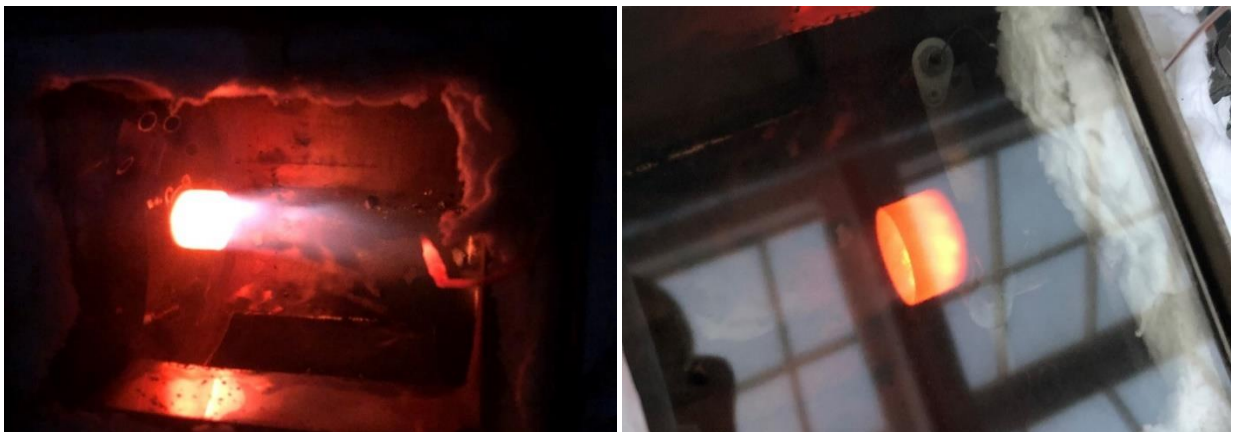
Figura 3. Experimente utilizand aer preincalzit la 405°C.
