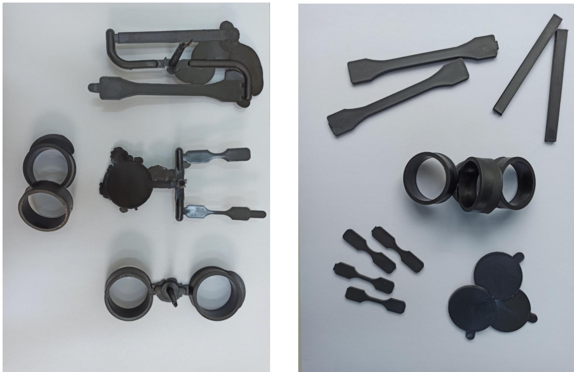
Figura 1. Componente obținute din material polimeric termoplastice (din surse bioregenerabile) pe bază de structuri grafenice în cadrul proiectului component 1 (în stânga componente neconforme obținute prin injecție, iar în dreapta componente conforme realizate prin injecția din topitură a materialului compozit și tehnologia dezvoltată în finalul proiectului)
