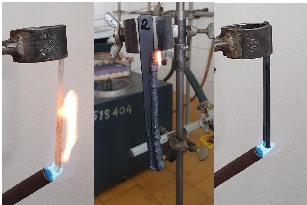
Figura 2. Epruvetele obținute din material polimeric compozit cu structuri 2D, ignifugat în diferite stadii ale dezvoltării, plecând de la materialul polimeric inițial inflamabil și până la cel final ignifugat clasa V-0 (conform UL94) dezvoltat în cadrul proiectului.
