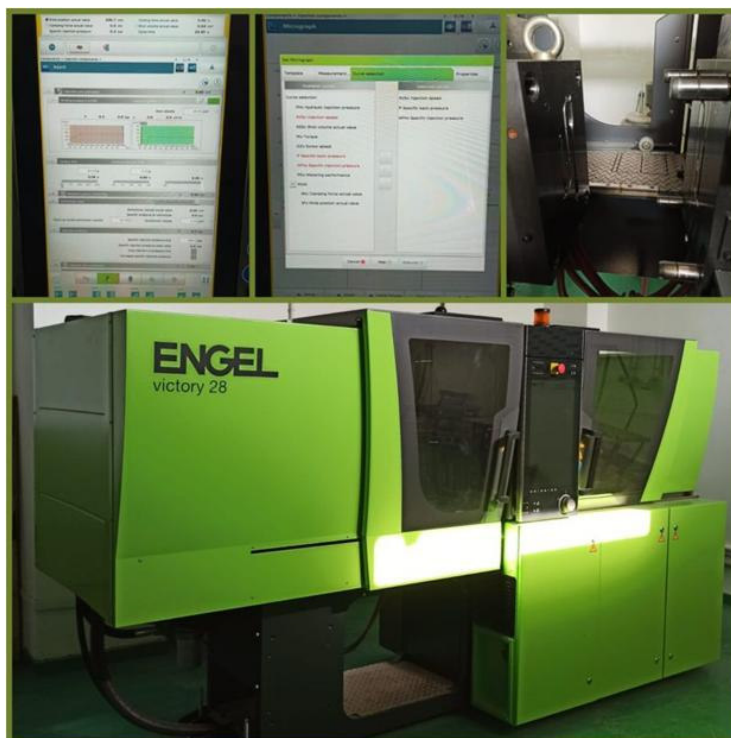
Figura 4 Mașina de injecție cu unitate superioară de plastifiere (inclusiv polimeri speciali și tehnopolimeri) cu capabilități pentru industria 4.0
